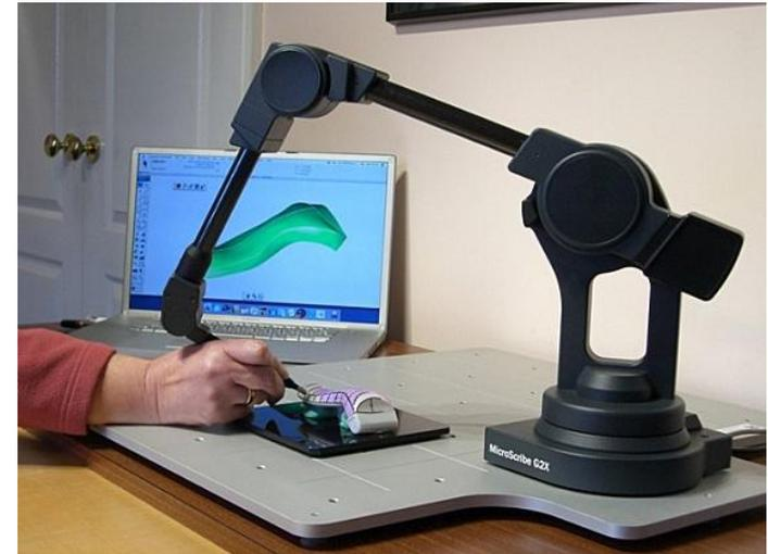
Abbildung 2: MICROSCRIBE 3D, handgeführter taktile Scanner [2]
