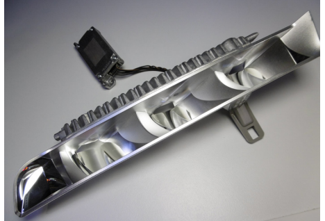
Tagfahrlicht, vermutlich VW, mit geöffnetem Steuergerät
