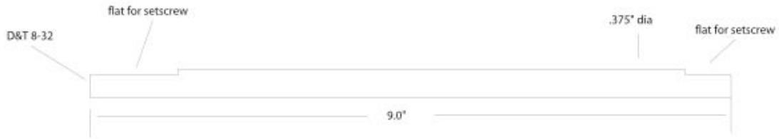
**Figure 4: Stud shaft extension**
