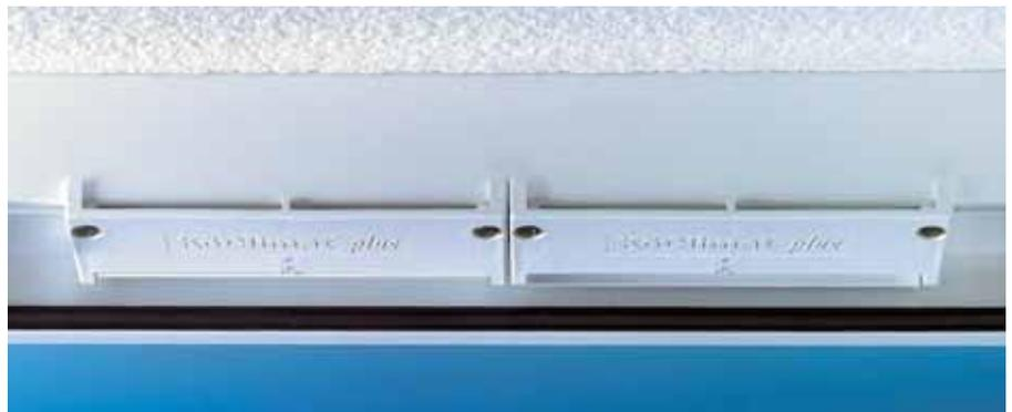
Die wenige Zentimeter großen, unauffälligen Elemente sind fest im Fensterahmen integriert. Sie benötigen keinerlei motorische Energie oder manuelle Bedienung. Aufgrund ihrer raffinierten Technologie nehmen sie ihre Lüfterfunktion in zwei Stufen wahr. Der jeweils auftretende Druck oder Sog öffnet oder schließt die Wippe wie ein Ventil und passt so die eintretende Frischluft und die abgehende Raumluft ständig dem physikalisch erforderlichen Luftaustausch an.
