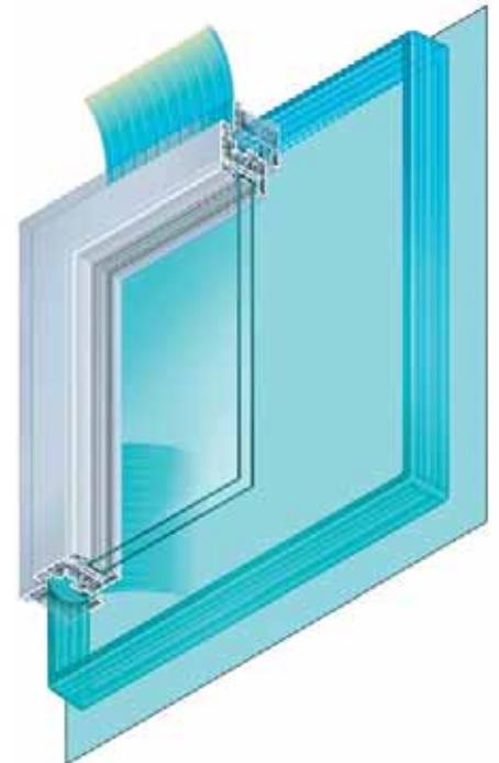
Im Rahmenprofil ist die Druckausgleichsdichtung deutlich erkennbar. Sie lässt situationsgerechte Mengen Frischluft in den Fensterfalz ein, ohne dass der Wärmeschutz darunter leidet. Die Frischluft steigt im Fensterfalz auf und wird dabei temperiert.
