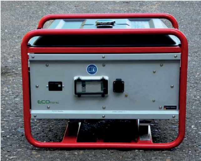
Abb. 5: Stromerzeuger nach Ausführung „A“ mit nur einer Steckdose zum direkten Anschluss von nur einem Betriebsmittel, zusätzliche Schutzmaßnahmen sind nicht erforderlich
