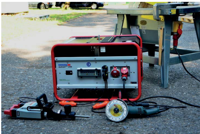
Abb. 11: Anschlussbeispiel von drei Betriebsmitteln an einen Stromerzeuger, Baustellenkreissäge direkt angeschlossen, Abbruchhammer und Trennschleifmaschine über je einen PRCD betrieben.
