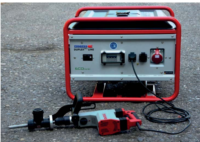
Abb. 7: Beispiel für einen Stromerzeuger der Ausführung A mit drei Steckdosen und nur einem angeschlossenen Betriebsmittel, zusätzliche Schutzmaßnahmen sind nicht erforderlich
