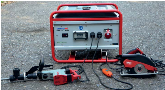
Abb. 10: Anschlussbeispiel von zwei Betriebsmitteln an einen Stromerzeuger, Abbruchhammer direkt angeschlossen, Handkreissäge über einen PRCD betrieben.
