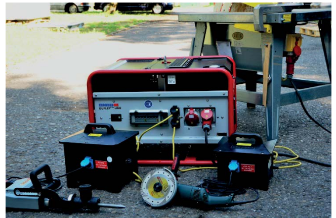
Abb. 9: Anschlussbeispiel von drei Betriebsmitteln an einen Stromerzeuger, Säge direkt angeschlossen, Abbruchhammer und Trennschleifmaschine werden bei „erhöhter elektrischer Gefährdung“ jeweils über einen Trenntransformator betrieben
