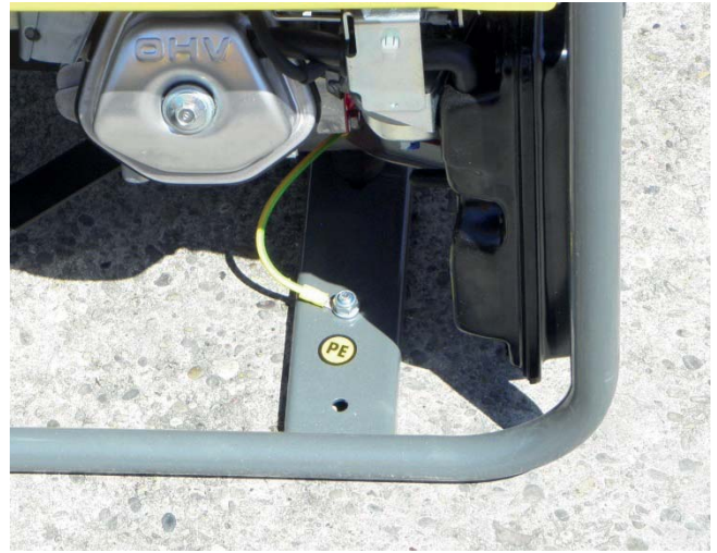
Abb. 2a/b: unrichtige Kennzeichnung des Potentialausgleichsanschlusses
