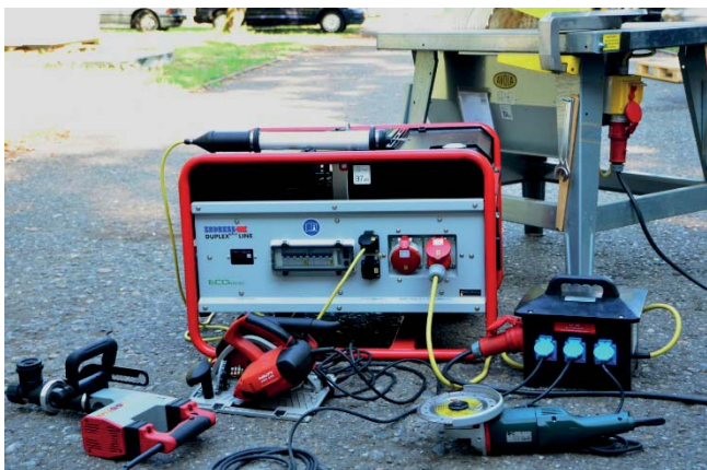
Abb. 13: Anschlussbeispiel von fünf Betriebsmitteln an einen Stromerzeuger, Handleuchte direkt angeschlossen, alle anderen Betriebsmittel über Verteilerbox mit RCDs betrieben.
